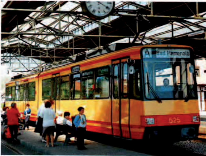
Bild 20.: Fahrzeugfamilie der Verkehrsbetriebe der Stadtverkehre Karlsruhe. Oben links: GT6-80C Oben rechts: GT8-100C/2S für Zweirichtungsverkehr mit Zweistromtechnik für 15 kV/16 2/3 Hz Wechselspannungs- und 750-V-Gleichspannungsbetrieb Rechts: GT8-80C mit Komfort-Panorama-Mittelteil (Fotos: DUEWAG)
