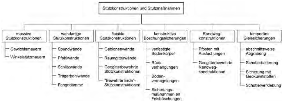
Abb. 11.1: Unterteilung der Stützkonstruktionen und Stützmaßnahmen
